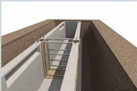
Plaatsen verloren bekisting Pose coffrage perdu
