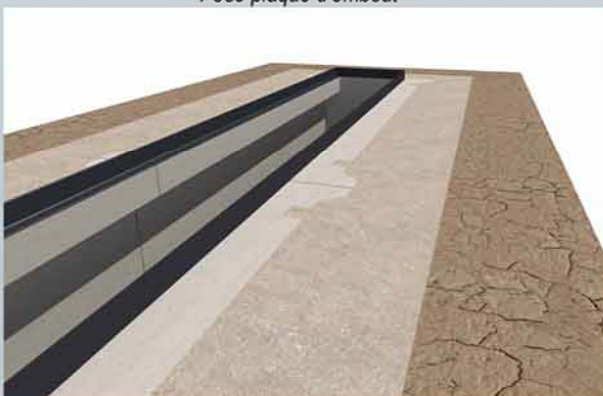
Aanvullen met gestabiliseerd zand en plaatsen randprofiel Remblais au sable stabilisé et pose profilés de bord de fosse
