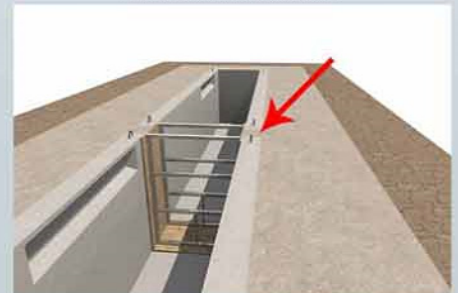
Vullen voeg met beton Remplissage au béton hydrofuge
